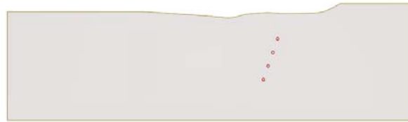
Figure 1 : Pièce inspectée contenant un groupe de trous « génératrices » sous la surface complexe de la pièce
