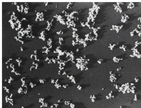
Figure 2: Photo MET issue de [2] montrant les agrégats de nanoparticules de silice obtenus lors du processus de fabrication de la silice pyrogénée
