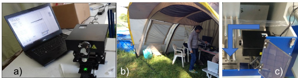
Figure 3 - Exemples d'utilisation de notre capteur pour le suivi de pollution dans des conditions difficiles (ici sous une tente (b)) et pour l'étude des propriétés de films polymères en temps réel (la flèche bleu représente le mouvement du film devant le capteur), dans ce second exemple le faible encombrement de ce capteur est un atout très important.
