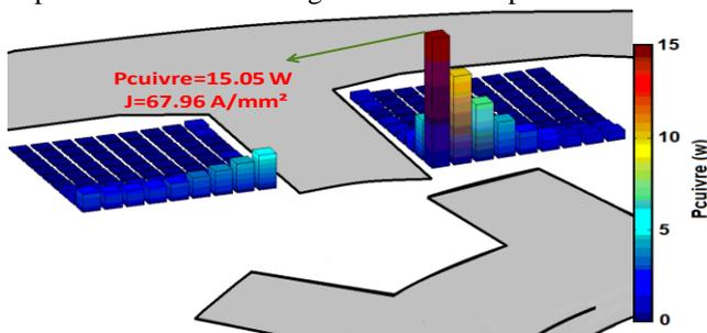
Fig. 1. Pertes cuivre en moyenne (Conducteur massif)
