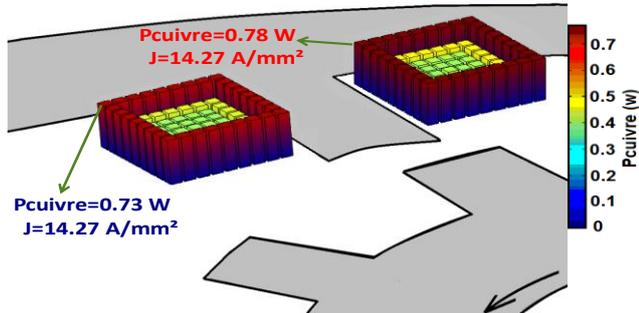
Fig. 2. Pertes cuivre en moyenne (Conducteur en 81 FT)
