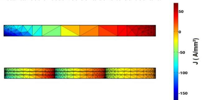
Fig. 4. Distribution de la densité du courant dans le conducteur à la proximité de l'entrefer à l'instant du maximum de pertes
