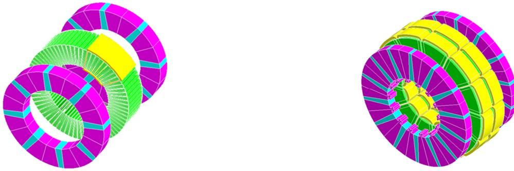
(a) Machine à flux axial à aimants enterrés et bobinage réparti (b) Machine à flux axial à aimants enterrés et bobinage concentré
