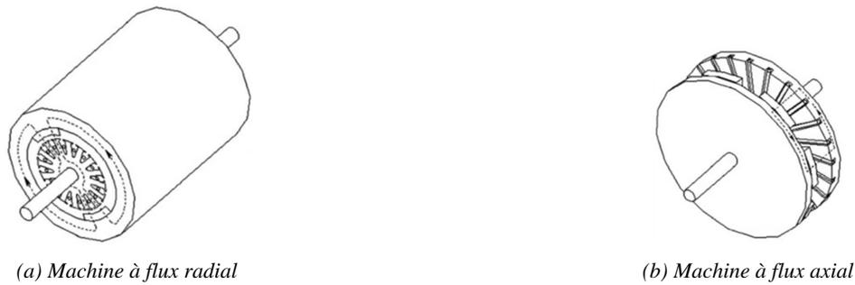
**Figure 2-10— Machines à flux radial et axial [Gier08]**
